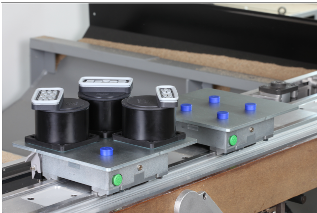
Adapter-Plates ISAP-B mit Mono-Bases und Sauger-Cups zum Aufspannen von Holzbauteilen
